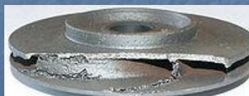
Uszkodzenia śruby w wyniku kawitacji
